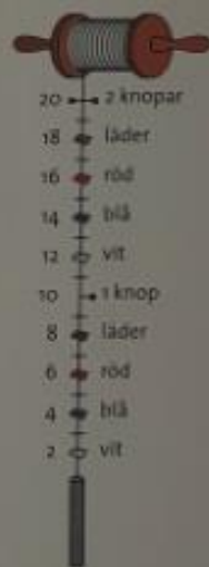
Fig 5:23 Det klassiska handlodet kan än i dag komma till användning om du tex vill handläda i en hamn.
