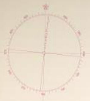
Kompassros ur sjökortet. Missvisningen är här 4,5° östlig och ökar med 0,1° per år.
