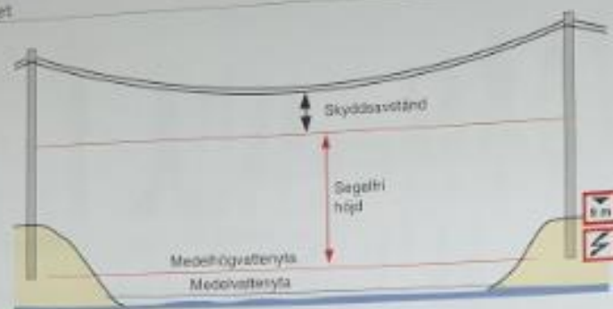
Principen för angivelser av segelfri höjd under kraftledning.
